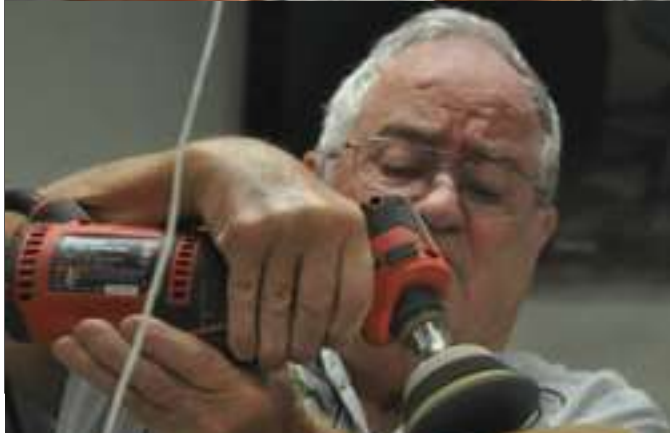
Routing Bow Tie recess for river pour
